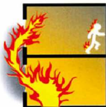
▲ 周圍外牆玻璃炸裂引燃室內物品
