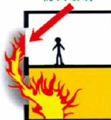
▲ 室外發生火災時，高強度單層防火玻璃有效抵禦火焰及煙霧入侵，保障室內生命和財物安全。
